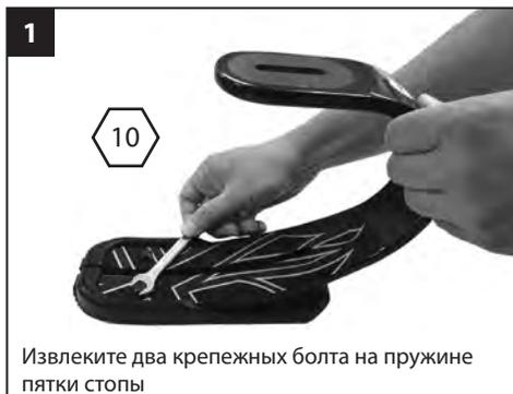
Извлеките два крепежных болта на пружине пятки стопы
