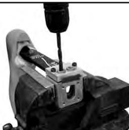
Теперь аккуратно просверлите два отверстия диаметром 8,1 мм через втулки кондуктора, сверление проводится строго перпендикулярно плоскости *динамической опоры-голень* стопы.
