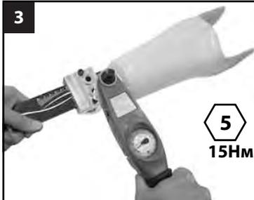
Затяните винты *клинического стяжного адаптера-кондуктора* с усилием в 15 Нм (дважды проверьте затяжку каждого болта).
