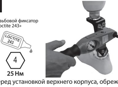
Перед установкой верхнего корпуса, обрежьте мысочную пружину опоры, используя метод, показанный ранее. Примените резьбовой фиксатор «Loctite 243» и затяните болты с усилием в 25 Нм. При необходимости повторно установите косметическую облицовку.
