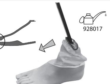
Вставьте сборку в скользящем носке в смазанную тефлоновой смазкой 928017 косметическую калошу. Установите мысочную пружину опоры голени во внутренний паз мысочной части косметической калоши.
