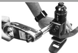
Подсоедините пружину мыска к несущей стопе, на резьбу крепежных болтов следует нанести небольшое количество резьбового фиксатора «Loctite 243» (шифр 926012).
