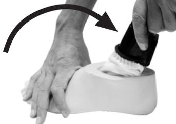
Осторожно поверните сборку несущей стопы/ пружину пятки в направлении к задней части стопы, и извлеките пружину пятки из паза внутри косметической калоши.
