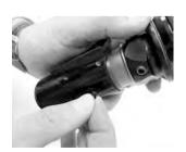
10 Установите торсионный амортизатор VT на стопу Elite Blade при помощи болтов, входящих в комплект торсионного амортизатора, нанесите на резьбу небольшое количество фиксатора Loctite 243 и затяните с усилием в 25Нм.
