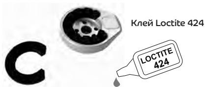
Рис. 2. Установка амортизатора плантарфлексии средней жесткости
