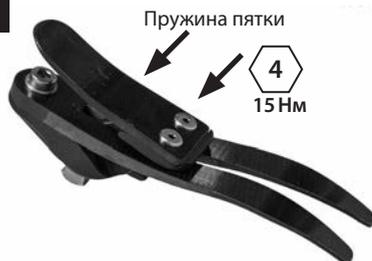
Установите на сборку несущей пружину пятки стопы, при сборке используйте резьбовой фиксатор Loctite 243 (926012) и затяните болты с усилием в 15 Нм.
