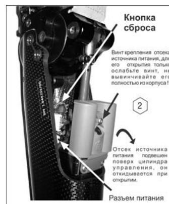
Батареи заменяются только попарно. Коленный модуль использует две батареи (литиевый элемент CR17345, напряжение 3В)
